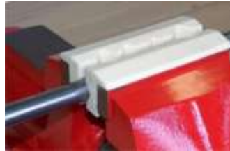
2. ábra Műanyag satupofa (mágneses rögzítésű)
